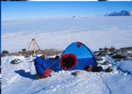
下右 [写真5] 南極セールロンダーネ山脈東部クラッケン=ヌナタクの三角点 (26°25'E, 72°00'S, 1312.4 m) の測量キャンプ。三脚上にGPSのアンテナがセットしてある。1991年1月22日撮影。
